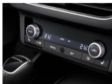
CLIMATRONIC - dwustrefowa klimatyzacja automatyczna z przyciemnianym lustrem wstecznym
